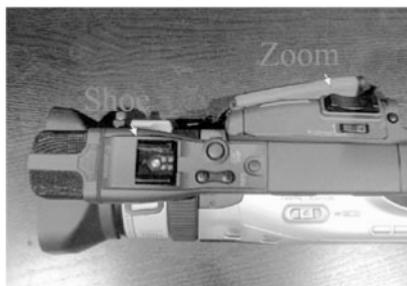
*La ‘zapata’ es donde usted conecta un dispositivo externo tal como una luz o un micrófono. El botón del ‘zoom’ le permite acercar o alejar el objetivo.*
